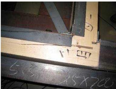
写真3 試験体3の最終破壊状況
