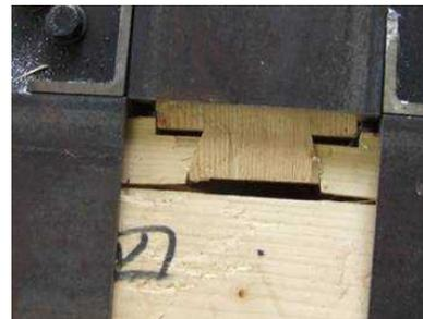
写真4 試験体4の最終破壊状況
