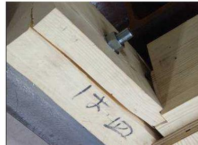
写真1 試験体 1 の最終破壊状況
