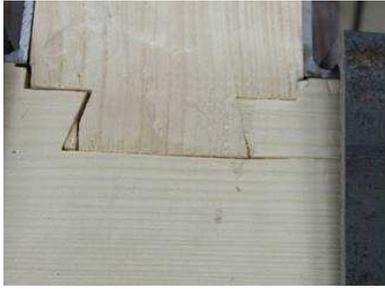
写真2 試験体2の最終破壊状況
