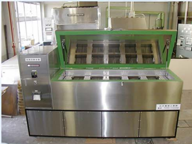
写真1 塩害試験装置国産1号機
