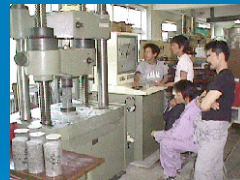
コンクリートの強度試験 (1000kN万能試験機)
