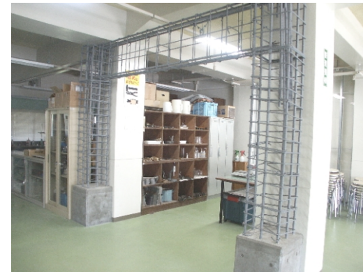
鉄筋コンクリート骨組みのサンプル
