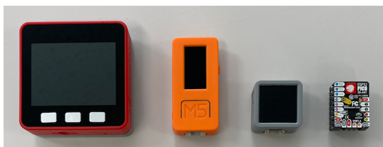
図 1 ESP32 を搭載したマイコンモジュール (左から M5Stack, M5StickC, M5Atom, M5StampPico)
