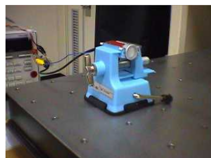
図2. 電力伝送実験で使用したトランスデューサ
