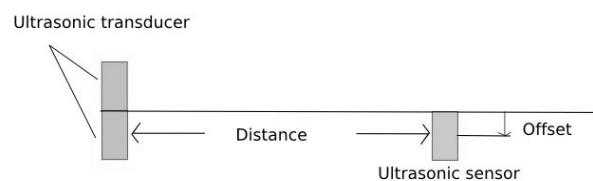
図1. 実験に用いた超音波トランスデューサおよびセンサの配置
