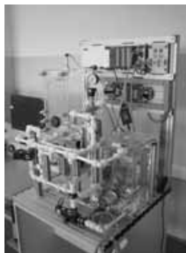
写真 4：流量制御実習のための小型プラント
