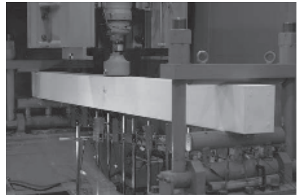
写真1 衝撃荷重実験の実験状況
