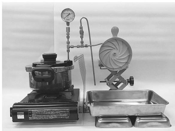
図 1 改良した汽力発電模型の概観
