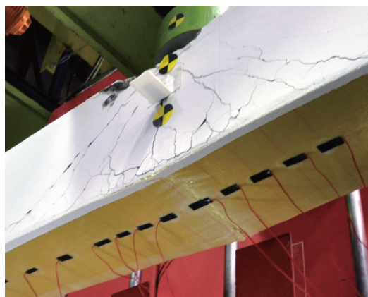
写真2 AP-H3.5 試験体の破壊性状
