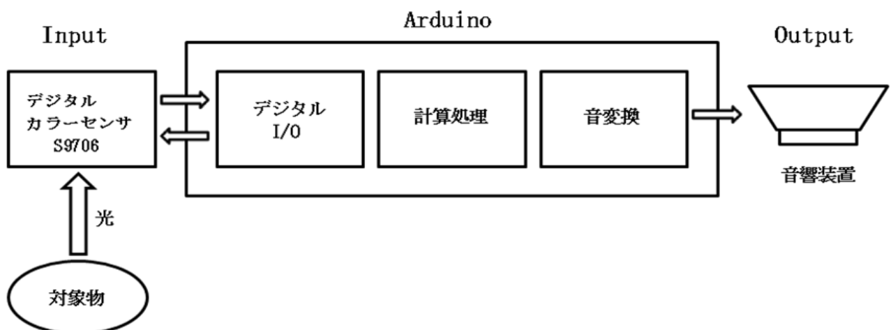
図 6 色識別装置のブロック図
