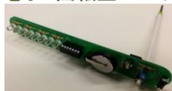
表示する文字パターンを自分で作ることができるLED表示装置を製作します。LED列が回転すると空中に文字が浮かび上がります。
