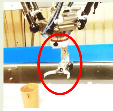
ロボットに試作アームを装着して稼働テストを実施
