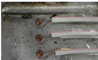
図1 残留応力測定
