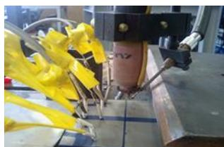
図2 溶接温度測定
