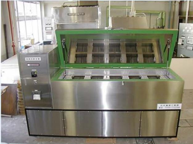
写真1 塩害試験装置国産1号機
