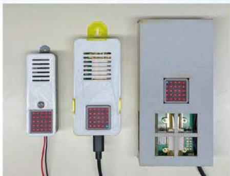
写真1 製作した簡易型CO 2 濃度計
